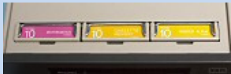
Slika 8a: Izgled položaja umetnutih ROM-ova (maksimalno tri istovremeno)
