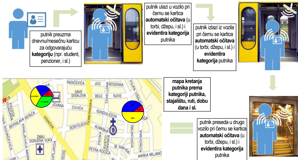
Slika 4 Primer upotrebe UHF RFID tehnologije sa mogućim izveštajem
