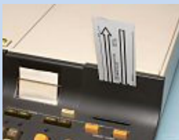
Slika 7: Detalj umetnute magnetne kartice pri učitavanju podataka ili programa
